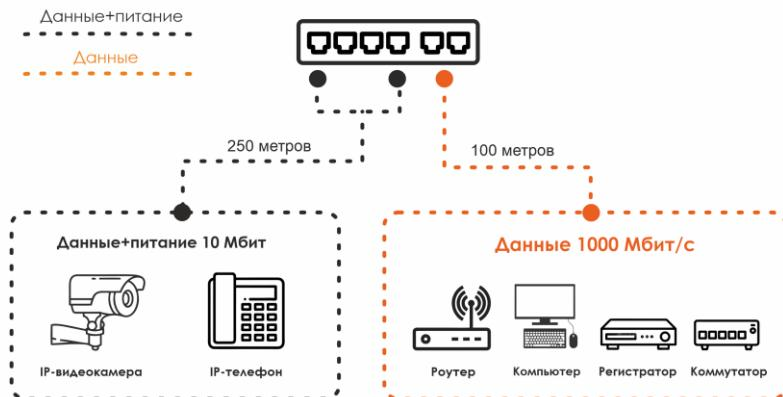
Коммутаторы имеют 2 режима работы, которые могут выбираться переключателем на передней панели:
